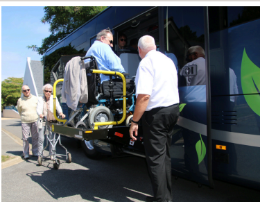
Plateforme élévatrice utilisée pour le transport des bénéficiaires en situation de mobilité réduite.
